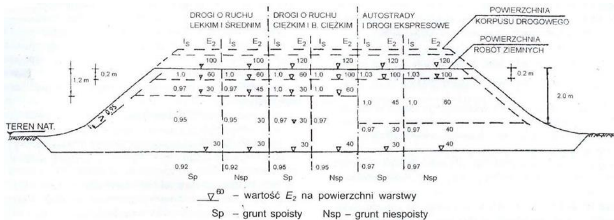
Rysunek 1 Wymagania dotyczące warstw nasypu wg PN-S-02205:1998
